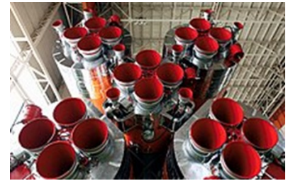
un moteur vernier est un propulseur complémentaire de faible poussée destiné à appliquer de fines corrections à la trajectoire d'un
